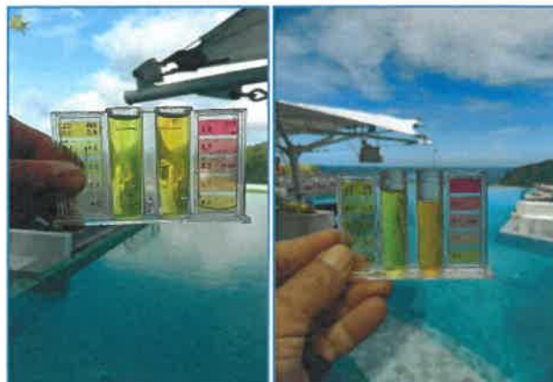
ภาพถ่ายที่ 3.4.2-1 ภาพถ่ายการตรวจวัดความเป็นกรดต่าง และค่าคลอรีนอิสระคงเหลือของสระว่ายน้ำ ในโรงแรมประจำวัน
